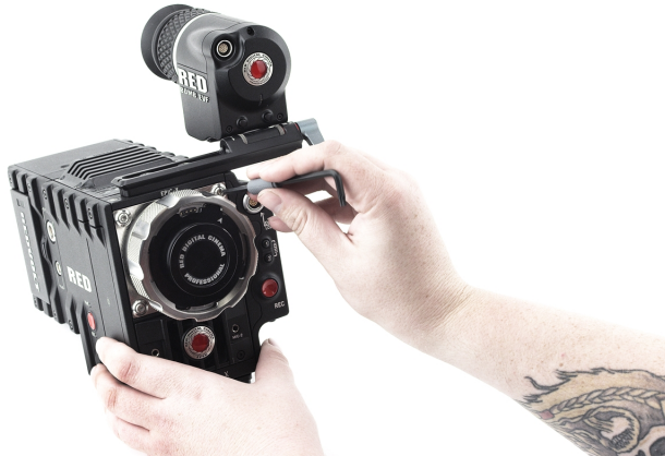
Figure: Entfernen Sie die Schrauben des Objektivaufsatzes
