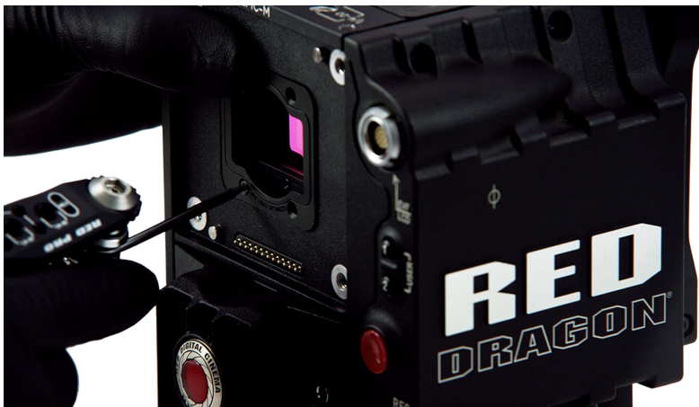
Figure: Bringen Sie das OLPF-Modul und die Schrauben wieder an
