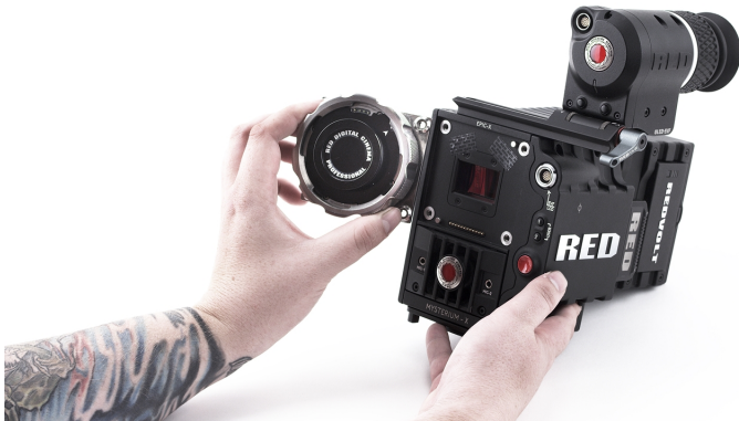
Figure: Ausrichten der Kontaktstifte des Objektivaufsatzes
