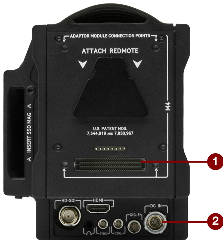
Figure: SEARAY コネクター (上) および DC IN コネクター (下)
