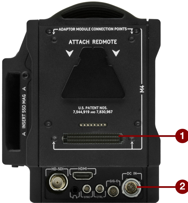
그림: SEARAY 커넥터(상부) 및 DC IN 커넥터(하부)
