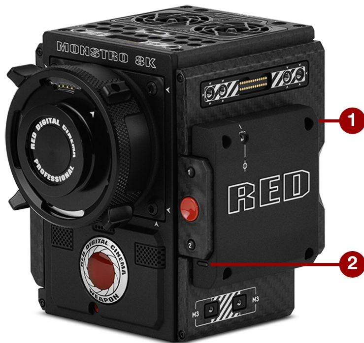
Figure: WEAPON のメディアベイの LED
