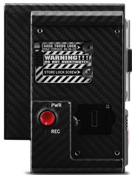
Figure: Back Focus (バックフォーカス) を調整するときはロックしない
