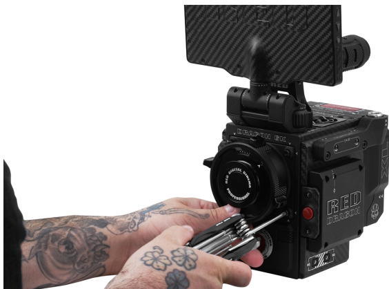
Figure: OLPF モジュールを取り外します
