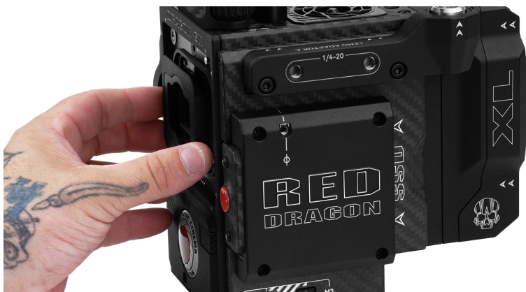
Figure: 新しい OLPF モジュールを取り付けます
