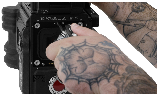
Figure: ロックを反時計回り 3 回します
