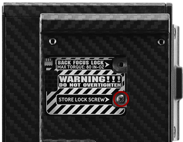
图：从储存锁定螺丝位置卸下螺丝
