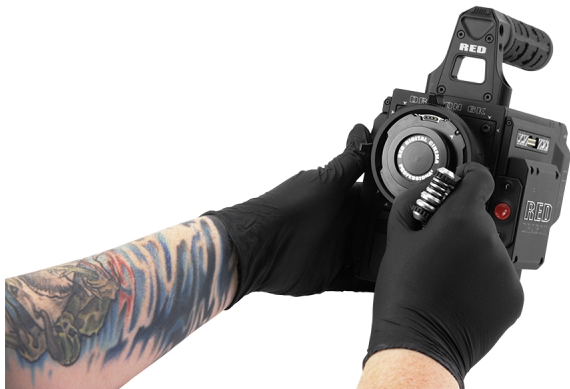
图：拆下镜头卡口螺丝
