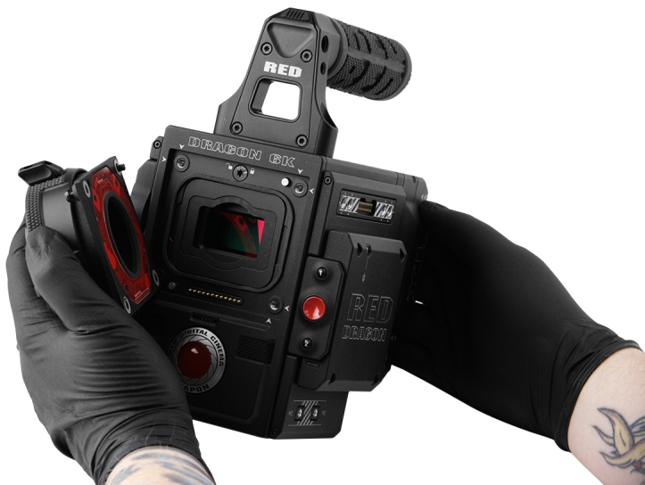
图：拆下镜头卡口
