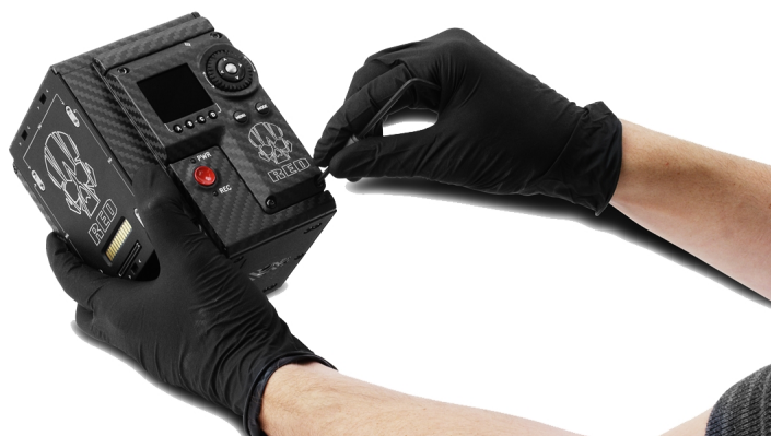
图：重新安装侧模块/面板
