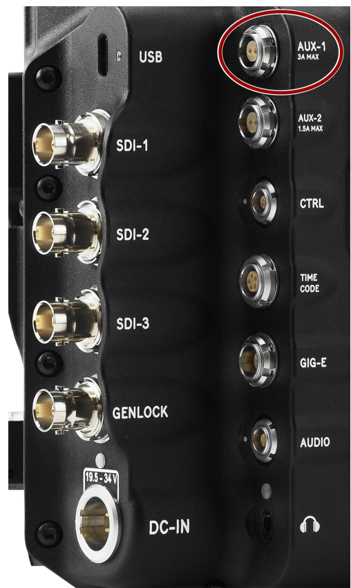
Abbildung: Vorderseite der AUX-1-Buchse (Blick auf die Rückseite der Kamera).
