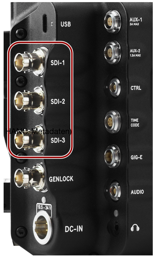
Abbildung: Vorderseite der 12G-SDI-BNC-Stecker (Blick auf die Rückseite der Kamera).
