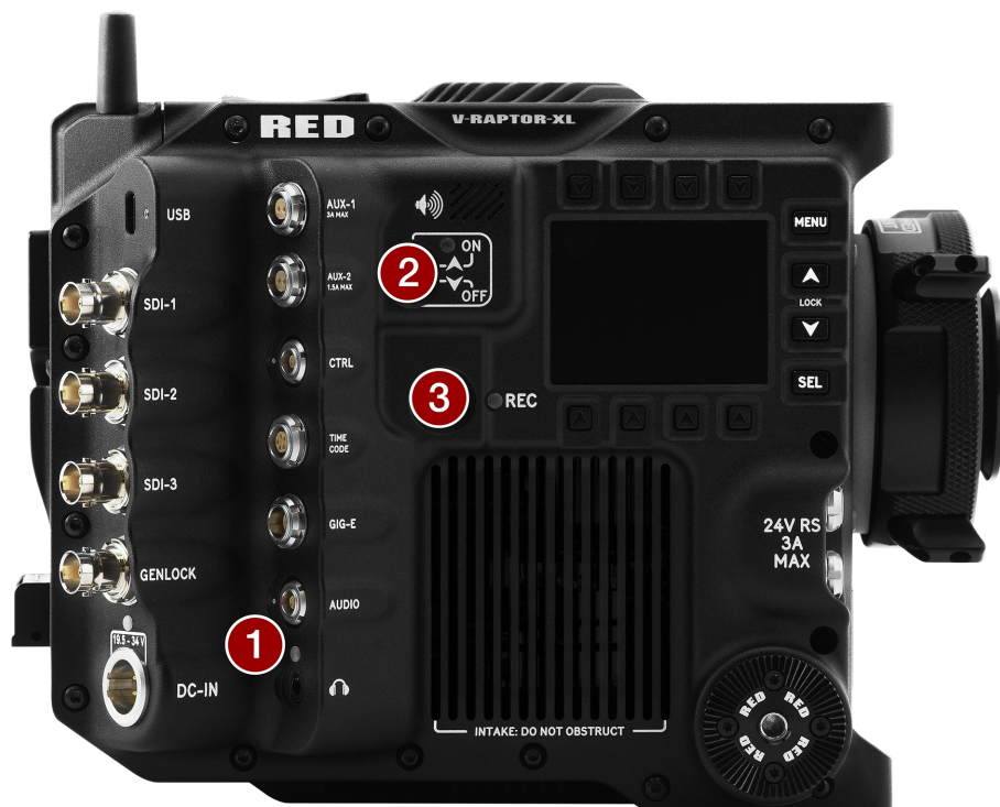
Abbildung: Kameragehäuse Rechte Seite LEDs
