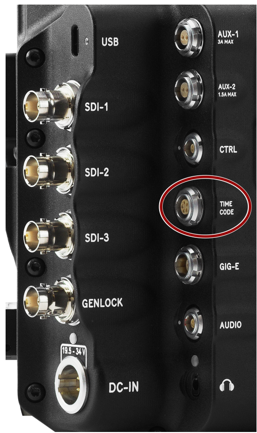
Abbildung: Vorderseite des Timecode 0B-Anschlusses (Blick auf die Rückseite der Kamera).
