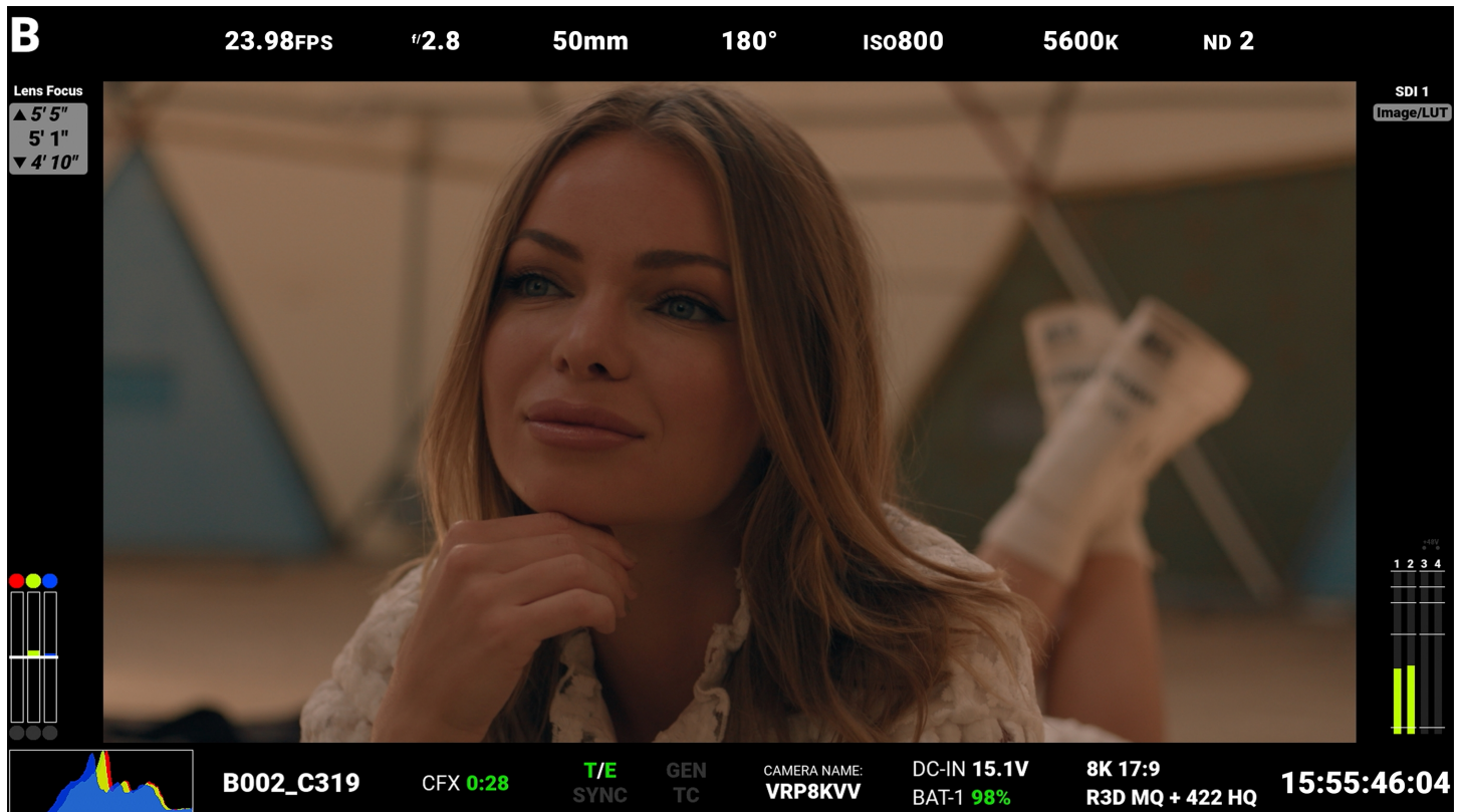
Abbildung: SDI-Monitor mit aktiviertem technischen SDI-Overlay-Modus
