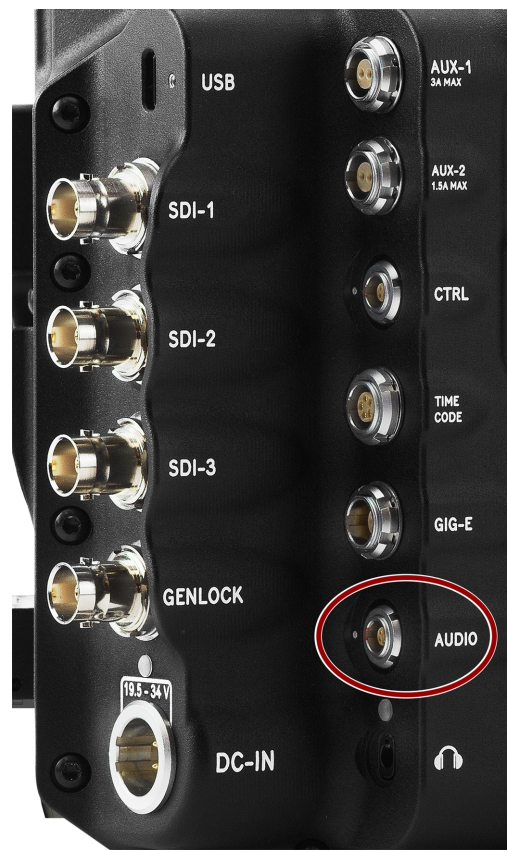
Figure : 雌性5针00B 音频连接器的正面( 看着相机的背面) 。
