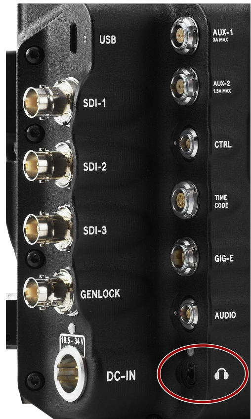
Figure : 母头3.5毫米耳机插孔的正面( 看着相机的背面) 。
