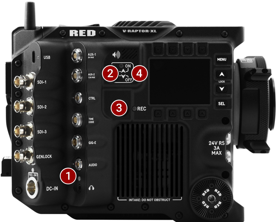
Figure : 相机机身右侧的LED
