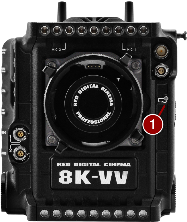
Figure : 相机机身前部LED
