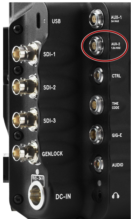
Abbildung: Vorderseite der AUX-2-Buchse (Blick auf die Rückseite der Kamera).
