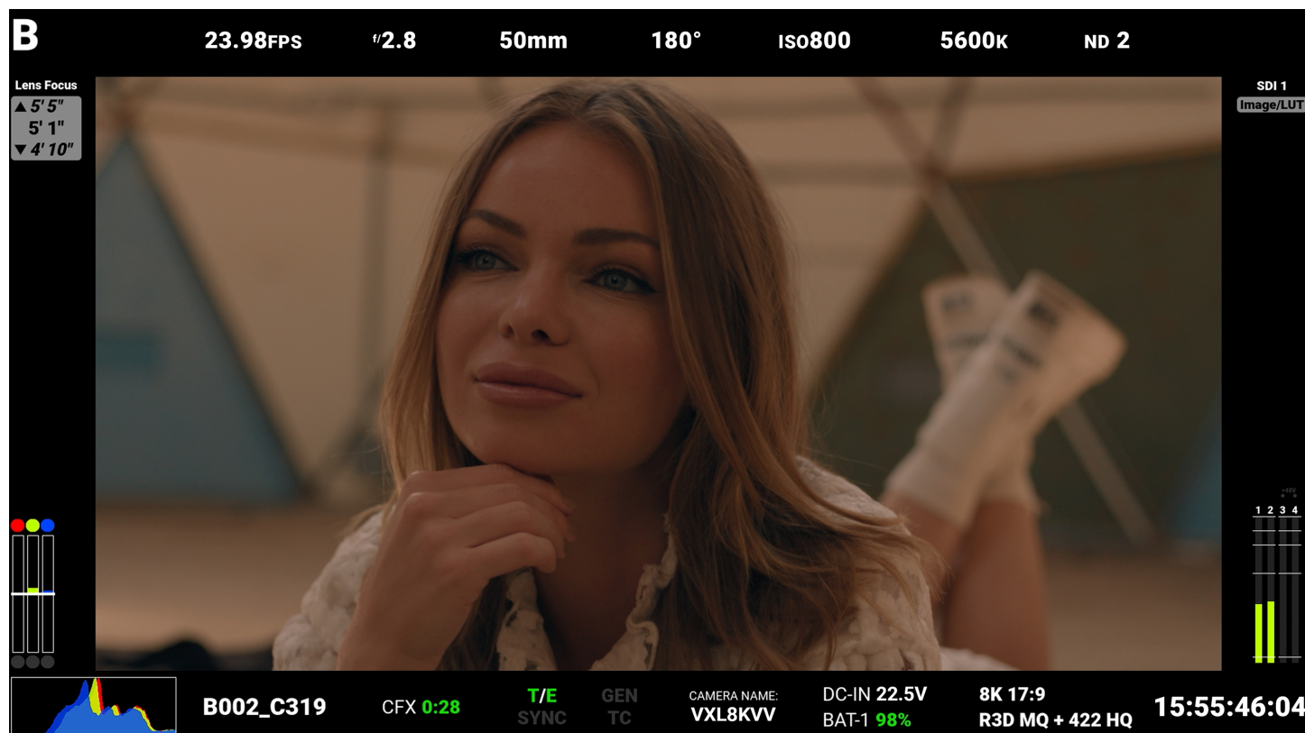
Abbildung: SDI-Monitor mit aktiviertem technischen SDI-Overlay-Modus
