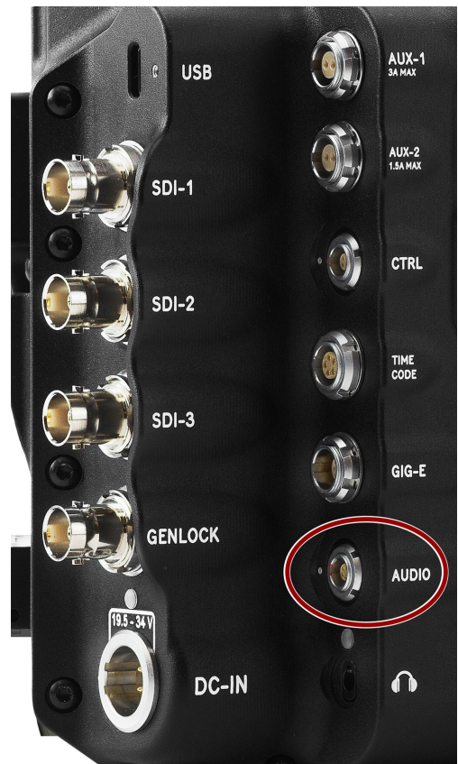
Abbildung: Vorderseite der 5-poligen 00B-Audiobuchse (Blick auf die Rückseite der Kamera).
