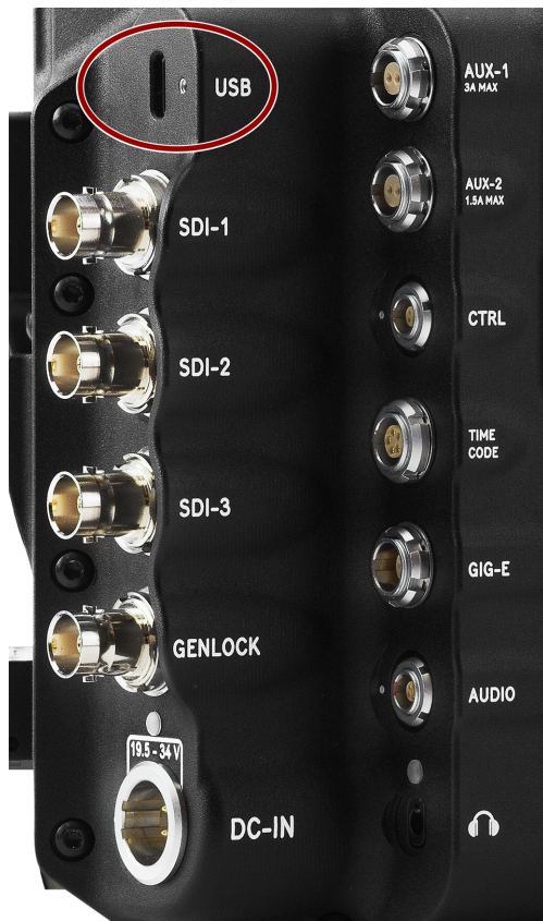
Abbildung: Vorderseite des USB-C-Anschlusses (mit Blick auf die Rückseite der Kamera).
