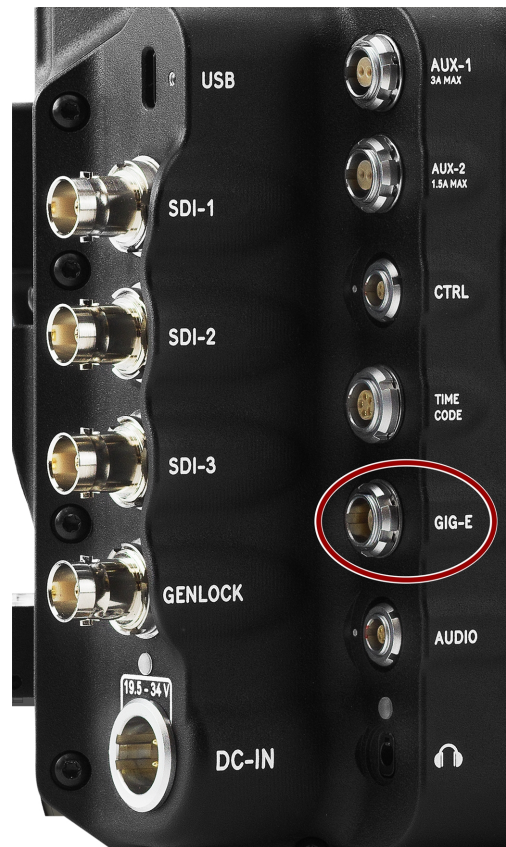
Abbildung: Vorderseite des GIG-E-Anschlusses (mit Blick auf die Rückseite der Kamera).
