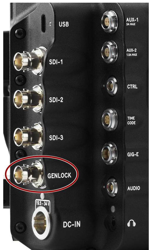
Abbildung: Vorderseite des Genlock-BNC-Steckers (Blick auf die Rückseite der Kamera).
