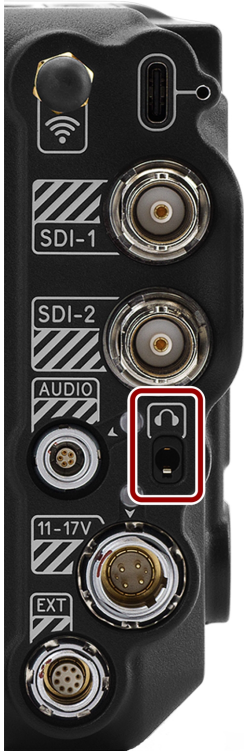
Figure : 母头3.5毫米耳机插孔的正面( 看着相机的背面) 。
