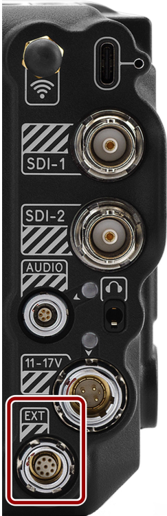
Abbildung: Vorderseite des weiblichen 9-Kontakt-Erweiterungsanschlusses (mit Blick auf die Rückseite der Kamera).
