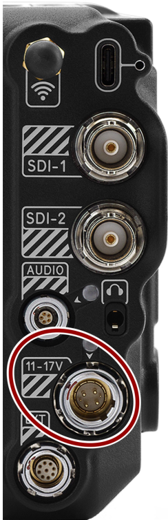
Figura: Cara frontal del conector macho de 6 patillas 1B de entrada de corriente continua (mirando hacia la parte posterior de la cámara).
