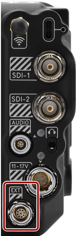
Figura: Cara frontal del puerto de extensión hembra de 9 contactos (mirando hacia la parte posterior de la cámara).
