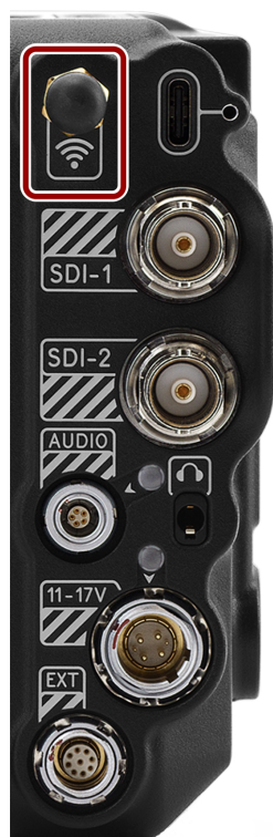
Figura: Cara frontal del puerto RP SMA hembra (mirando a la parte posterior de la cámara).
