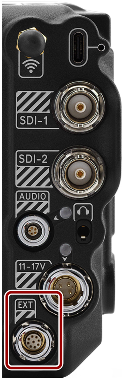
Figure : Face avant du port d'extension femelle à 9 contacts (en regardant l'arrière de la caméra).
