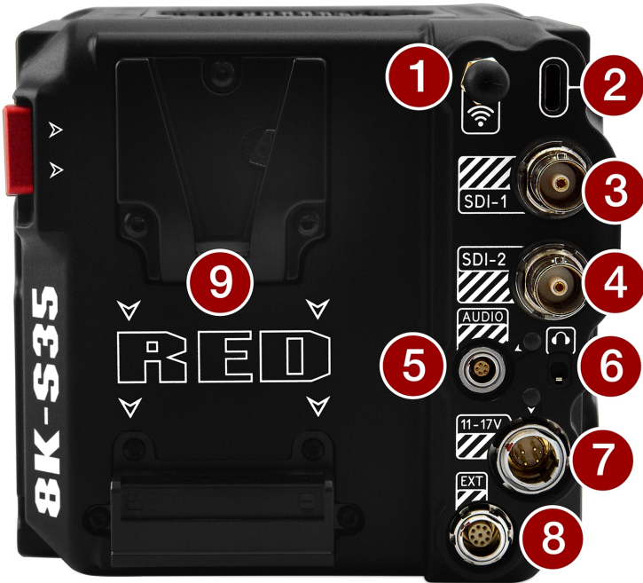
Figure : Commandes et caractéristiques du boîtier de la caméra arrière
