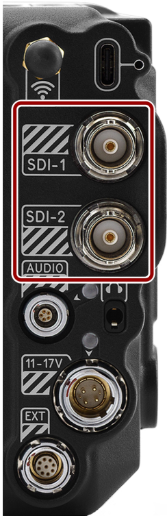
Figure : Face avant du connecteur BNC mâle 12G-SDI (en regardant l'arrière de la caméra).
