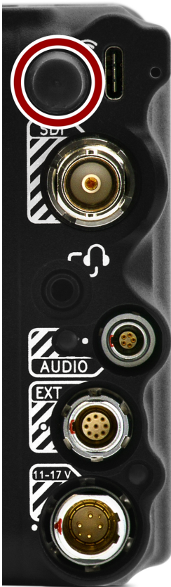
FC :Figure : Face avant du port RP SMA femelle (en regardant vers l'arrière de la caméra).
