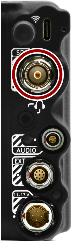
FC :Figure : Face avant du connecteur BNC mâle 12G-SDI (vue vers l'arrière de la caméra).
