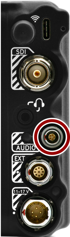
FC :Figure : Face avant du connecteur audio femelle 5 broches 00B (en regardant vers l'arrière de la caméra).
