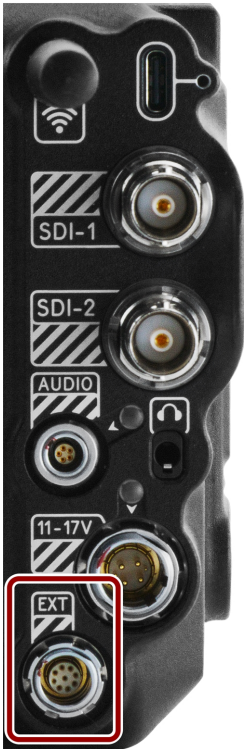
Abbildung: Vorderseite des weiblichen 9-Kontakt-Erweiterungsanschlusses (mit Blick auf die Rückseite der Kamera).
