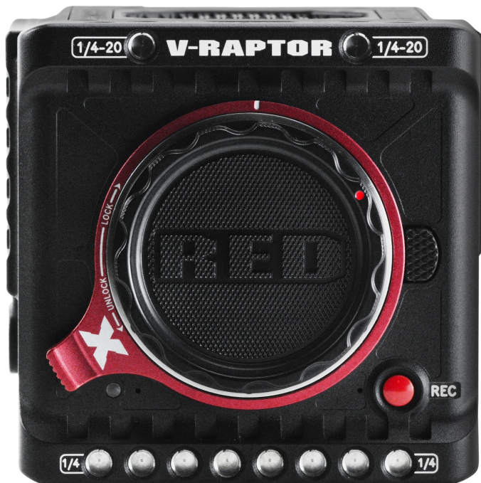
Abbildung: Kamera mit montierter Montagekappe.
