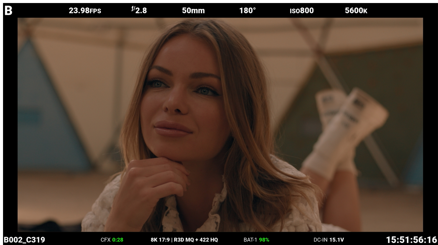
Abbildung: SDI-Monitor mit aktiviertem SDI-Standard-Overlay-Modus
