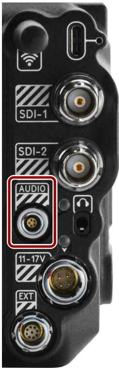
Abbildung: Vorderseite der 5-poligen 00B-Audiobuchse (Blick auf die Rückseite der Kamera).
