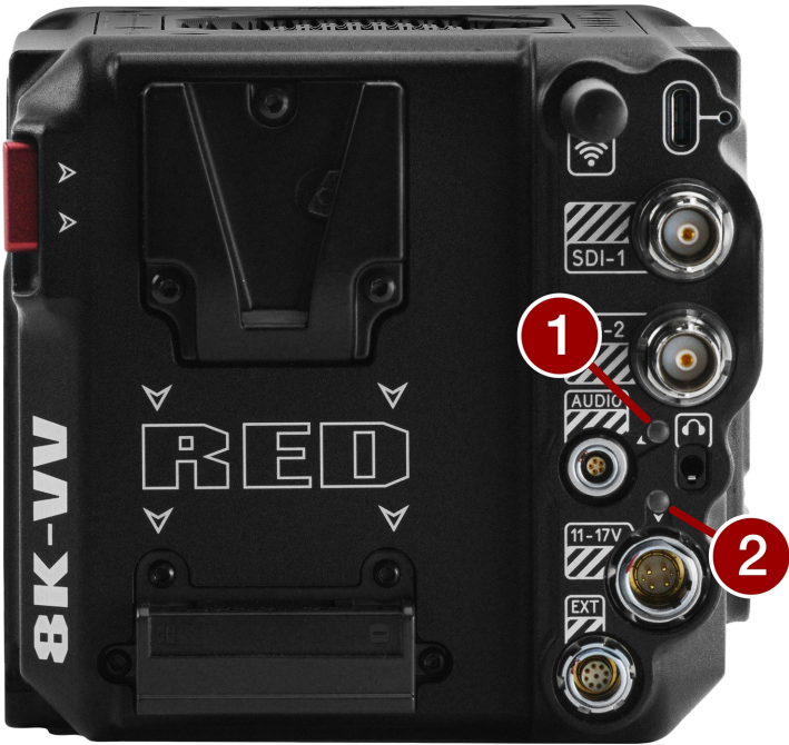
Abbildung: Kamera, LEDs auf der Rückseite
