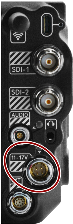
Figura: Cara frontal del conector macho de 6 patillas 1B de entrada de corriente continua (mirando hacia la parte posterior de la cámara).
