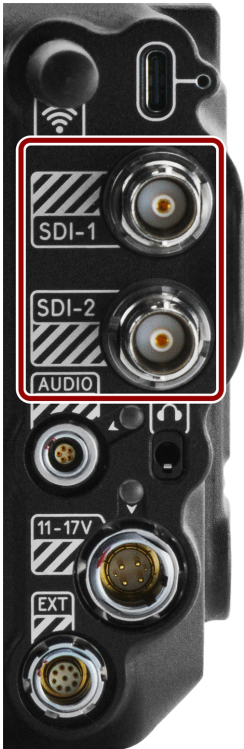
Figura: Cara frontal del conector BNC macho 12G-SDI (mirando a la parte posterior de la cámara).
