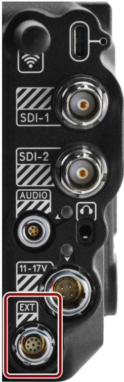
Figure : Face avant du port d'extension femelle à 9 contacts (en regardant l'arrière de la caméra). NOTE : Le connecteur correspondant requis est le connecteur droit à 9-pin 0L (ODU, part# SX0L0X-P09MCC0-0001).
