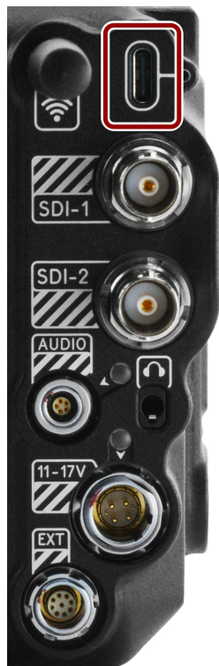
Figure : Face avant du port USB-C (en regardant l'arrière de la caméra).
