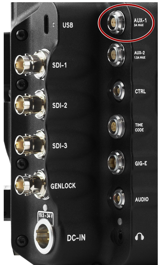
Figure :AUX-1母接头的正面( 看着相机的背面) 。
