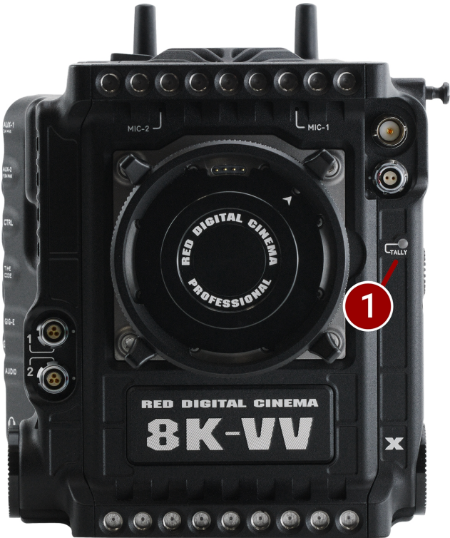
Abbildung: Kameragehäuse Front-LED
