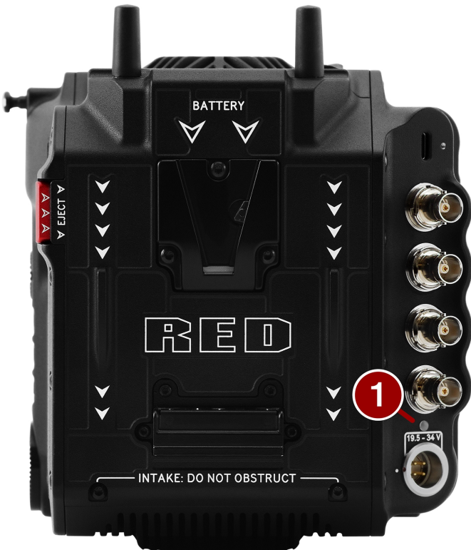
Abbildung: Kamergehäuse Rückseitige LED
