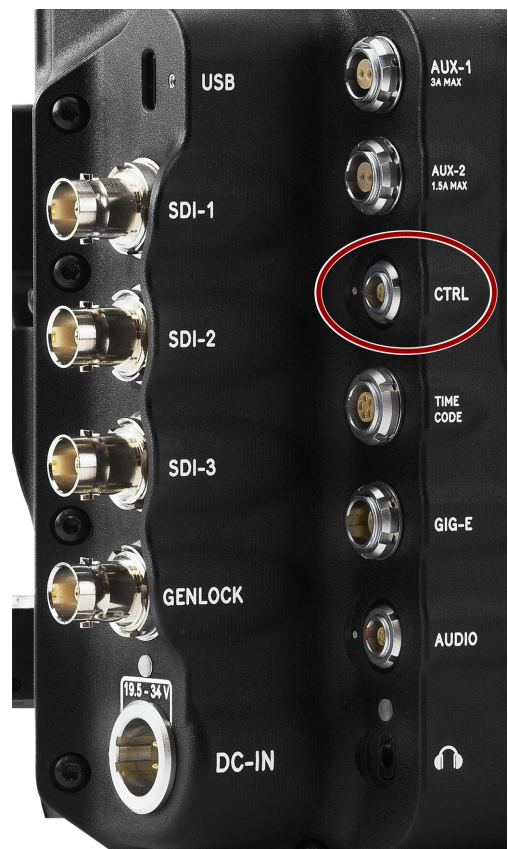
Abbildung: Vorderseite der 4-poligen 00B CTRL-Buchse (Blick auf die Rückseite der Kamera).
