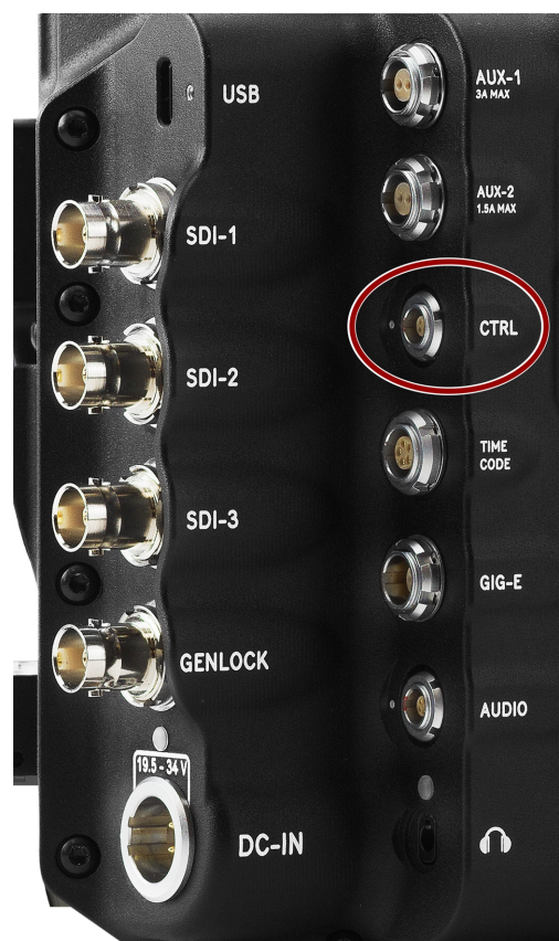
Figura: Cara frontal del conector hembra 00B CTRL de 4 patillas (mirando a la parte posterior de la cámara). El conector hembra LEMO de 4 patillas 00B CTRL admite el control remoto RS-232 para la comunicación con cámaras 3D y aplicaciones de ingesta de metadatos de terceros.
