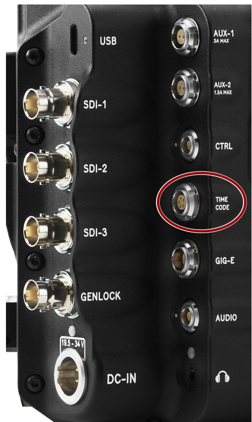
Figura: Cara frontal del conector Timecode 0B (mirando a la parte trasera de la cámara).
