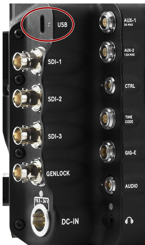
Figura: Cara frontal del puerto USB-C (mirando a la parte trasera de la cámara).
