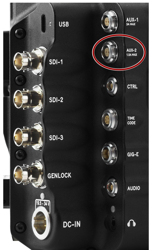
Figura: Cara frontal del conector AUX-2 hembra (mirando a la parte posterior de la cámara).
