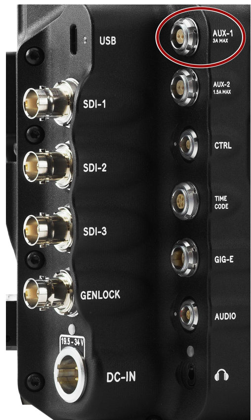
Figura: Cara frontal del conector AUX-1 hembra (mirando a la parte posterior de la cámara).
