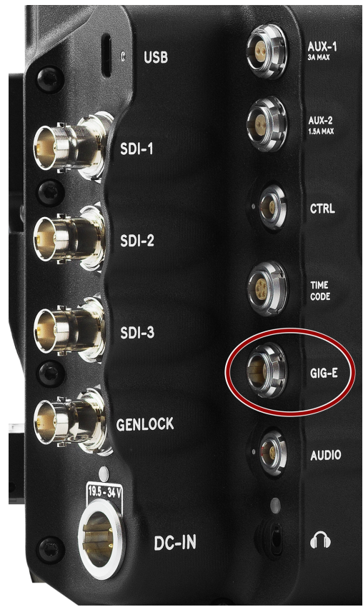
Figura: Cara frontal del conector GIG-E (mirando a la parte posterior de la cámara).
