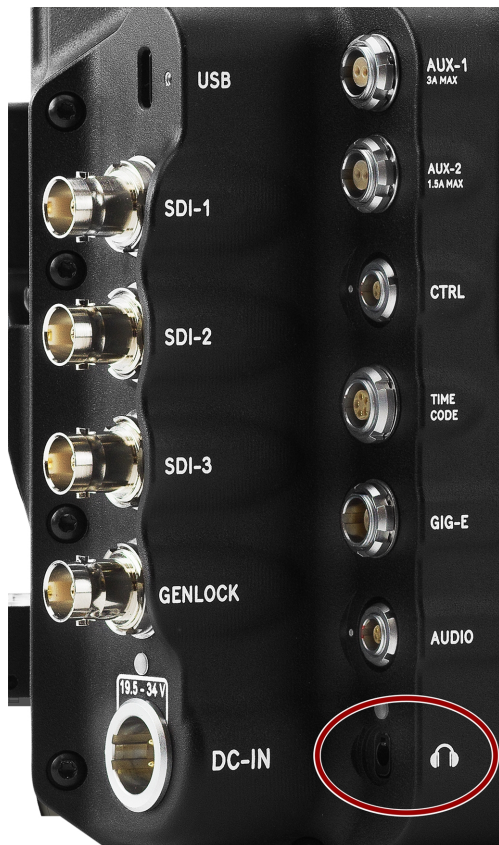
Figura: Cara frontal de la toma de auriculares hembra de 3,5 mm (mirando hacia la parte posterior de la cámara).
