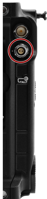
Figura: Cara frontal del conector hembra AUX EVF de 2 patillas (mirando a la parte frontal de la cámara).
